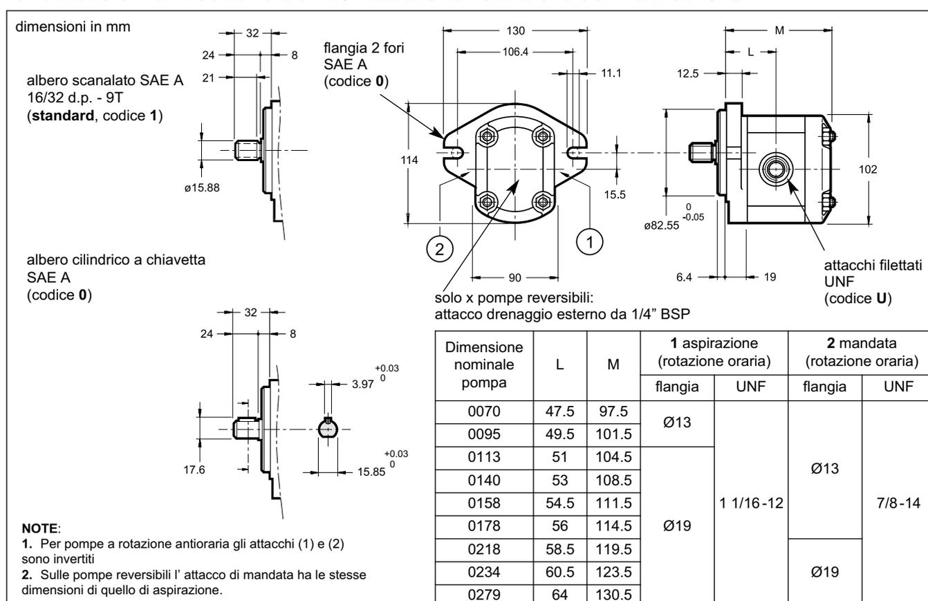
**11 - DIMENSIONI DI INGOMBRO E DI INSTALLAZIONE POMPE GP3 CON FLANGIA STANDARD**
