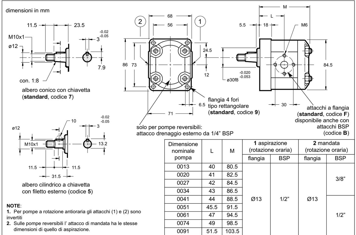
**8 - DIMENSIONI DI INGOMBRO E DI INSTALLAZIONE POMPE GP1 CON FLANGIA SAE**
