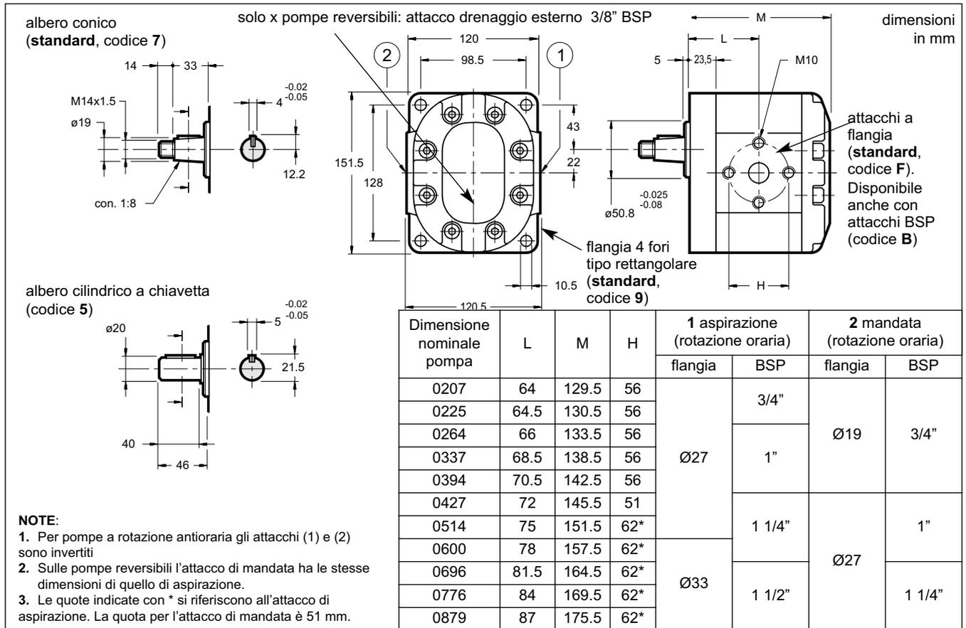
**12 - DIMENSIONI DI INGOMBRO E DI INSTALLAZIONE POMPE GP3 CON FLANGIA SAE**
